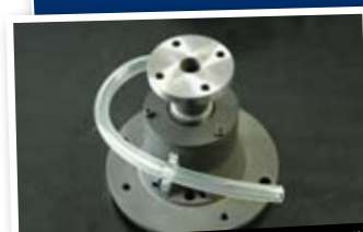
Mazací spojka, bez níž nelze bezpečně testovat vysokotlaká čerpadla Continental (Siemens)
