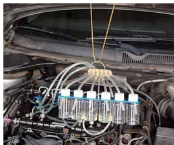
Některé vstřikovače vyžadují speciální redukce pro připojení odměrek
